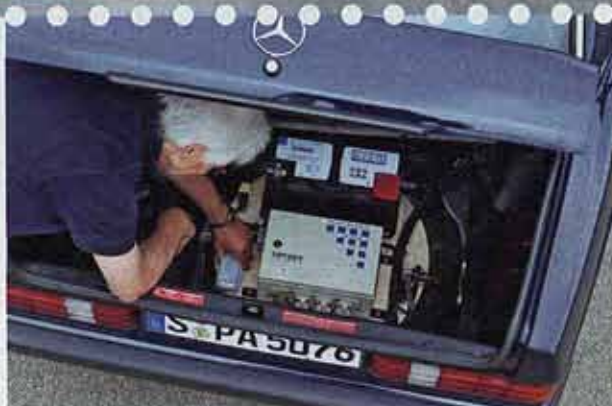
Mit diesem schweren Rechner muss der moderne Motor Daten austauschen - sonst springt er gar nicht erst an
